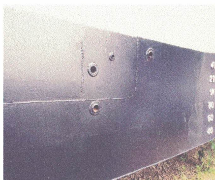
Figura 2 – Vista do sistema de governo, o mesmo deve ser reforçado na junção do casco.
